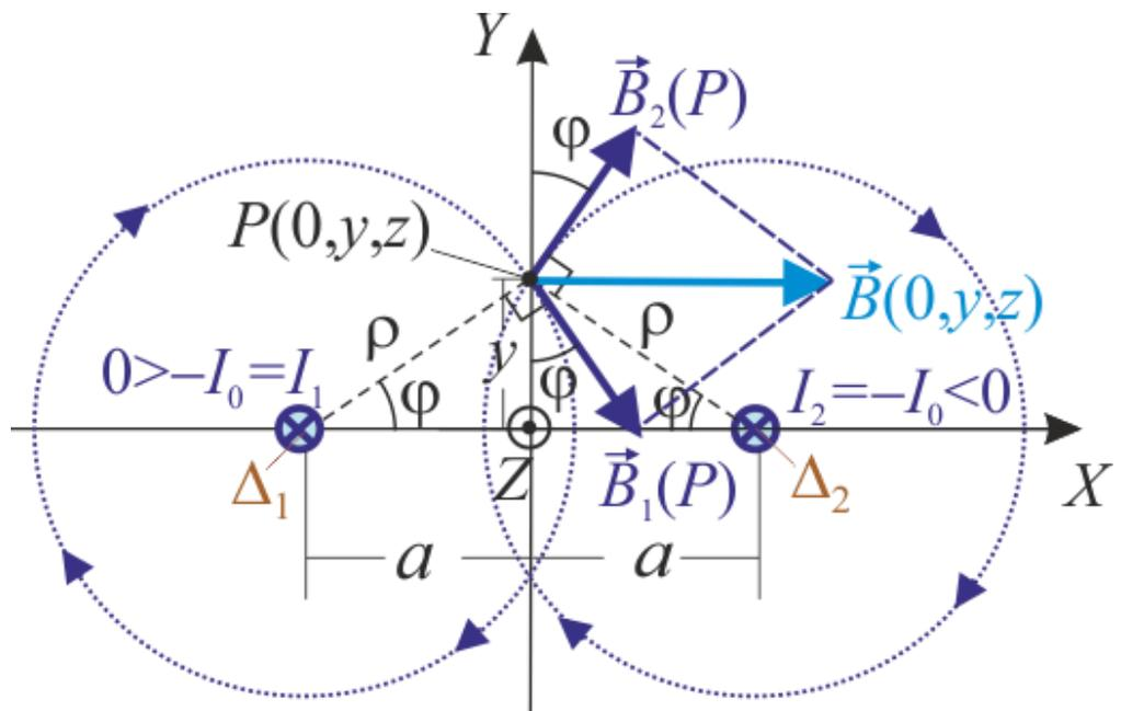
Utilizando de nuevo el ángulo  $\varphi$  definido en el apartado anterior se observa que, en el punto  $P(0, y, z)$ , los campos  $\vec{B}_1(P)$  y  $\vec{B}_2(P)$  se encuentran ambos al mismo lado del plano  $\Pi_{OYZ}$ , formando idéntico ángulo  $\varphi$  con éste (ver figura). Las expresiones analíticas de estos campos es:
